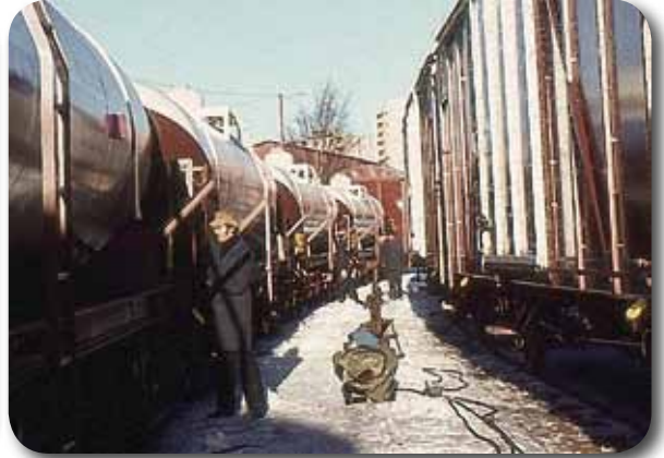
Kuva 97. Uusien säiliö- ja tavaravaunujen jarrulaitteiden tarkastus ja vastaanotto Pasilan konepajalla.
